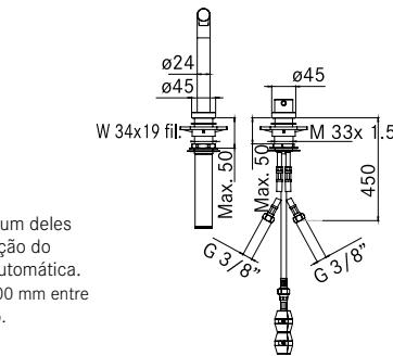
Requer orifício duplo; um deles pode ser em substituição do comando da válvula automática. Distância máxima de 500 mm entre misturadora e comando.
