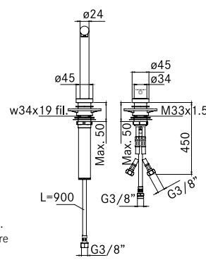
Requer orifício duplo; um deles pode ser em substituição do comando da válvula automática. Distância máxima de 500 mm entre misturadora e comando.
