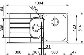
Nas instalações à face, é necessário perfurar o orifício e fazer o rebaixamento com base nas medidas/espessura do lava-loiças a instalar.
