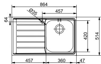
Nas instalações à face, é necessário perfurar o orifício e fazer o rebaixamento com base nas medidas/espessura do lava-loiças a instalar.
