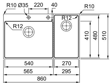
Nas instalações à face, é necessário perfurar o orifício e fazer o rebáixamento com base nas medidas/espaçamento do lava-loiças a instalar.
